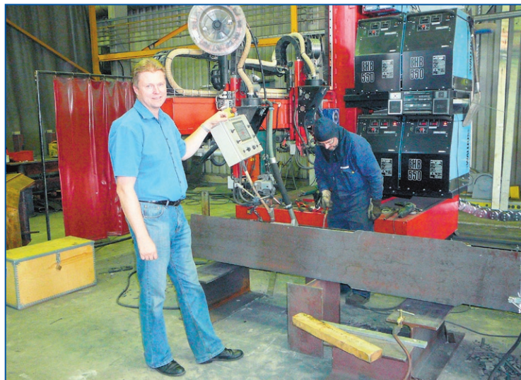
Toimitusjohtaja Ari Lindholm ja uusi jauhekaariautomaatti, joka nopeuttaa työskentelyä. Palkkia hitsaamassa Pekka Laakso.
