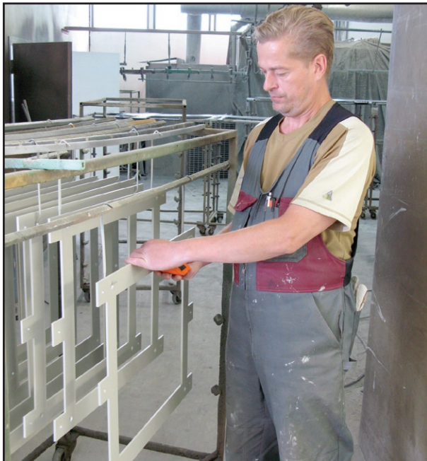
Juha Jokinen mittaa risteilylaivaan tulevien monitorikehysten maalikalvon paksuutta.
