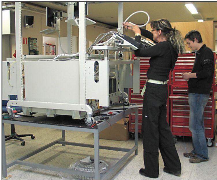
Liisa Sinkkonen ja työssäoppimisjaksoaan suorittava Eetu Skyttä kokoavat matkapuhelinten ohjelmointisolua.
