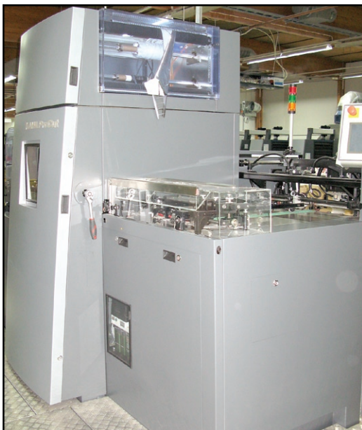
Monitoimisella KAMA stanssuskoneella voi myös folioida, preeglata ja perforoida.
